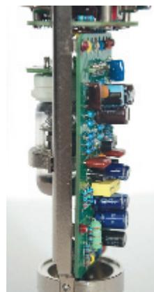
**Die Elektronik des V67i Tube besteht aus einer Röhren-Eingangsstufe und einer transistorisierten Ausgangsstufe.**
