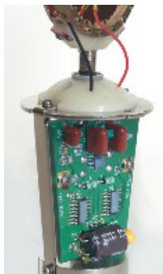
gangsstufe für den ihm vorgeschalteten diskreten FET bildet, der als Phasenteiler fungiert. Im Prinzip eine Abwandlung der guten alten Schoeps-Schaltung mit Operationsverstärkern statt diskreten Emitterfolgern.
