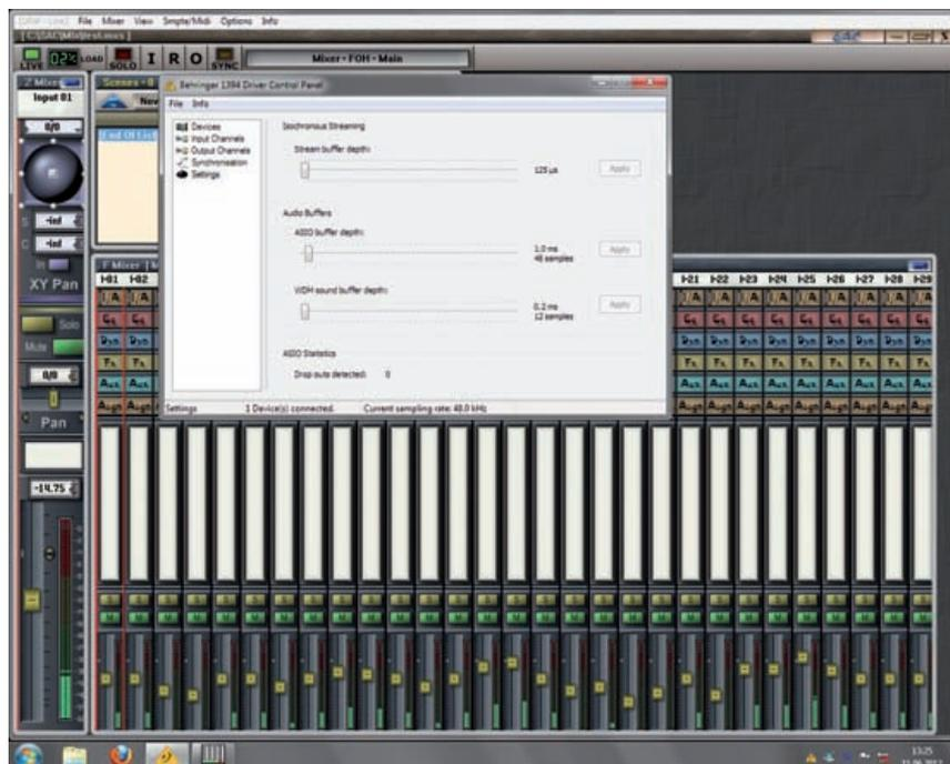
Die XUF Recording-Karte des X32 lässt mit entsprechender Computer-Hardware extrem niedrige Buffergrößen im Firewire-Betrieb zu; selbst 48 Samples sind damit möglich
