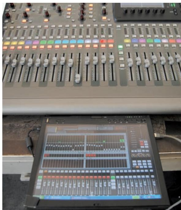
Die X32 Remote Software besitzt ein gelungenes GUI, das sich deutlich an der Oberfläche des X32 orientiert
