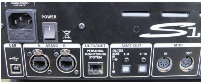
Im AES-50-Signal werden sogar das „Ultranet P16“-Signal und MIDI-Steuerinformationen mit übertragen, welche sich auf der Rückseite der S16 Stagebox wiederum abgreifen lassen
