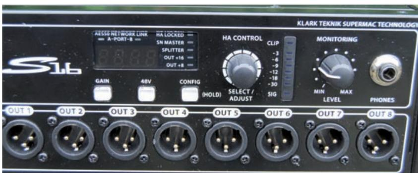
Die Mikrofonvorverstärker der S16 Stagebox können auch am Gerät bedient und über den Phones-Ausgang abgehört werden
