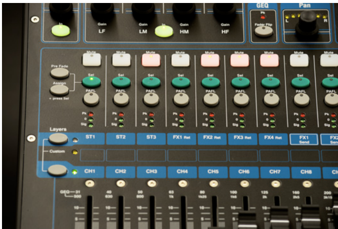
Blick auf die Mischebenen 1 (Kanalzüge, unten) und 2 (ST1-3, FX Send und Return etc, oben) und ihre physikalischen Bedienelemente.
