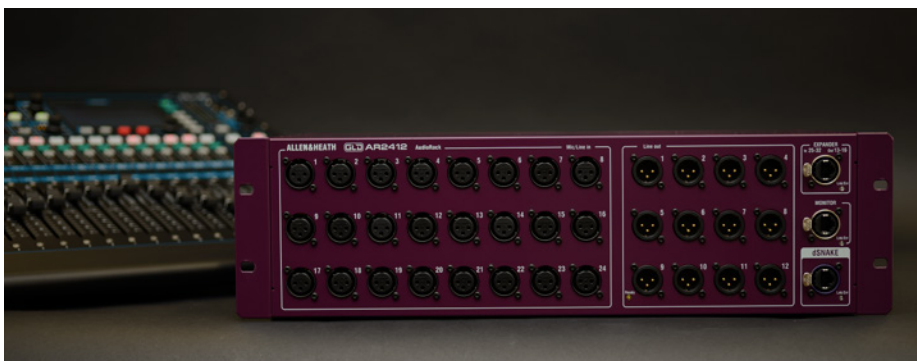
Das AR2412 Audio-Rack aus der GLD-Serie kommuniziert ebenfalls über das proprietäre Netzwerk-Protokoll mit dem QU-16.
