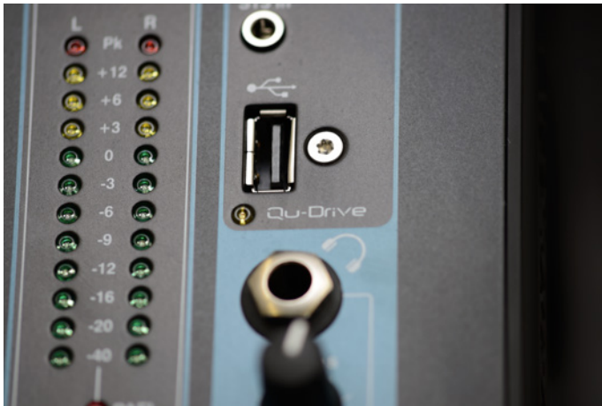
„Qu-Drive“ dient zum Anschluss einer USB-Festplatte oder eines USB-Sticks für rechnerunabhängige Mehrspurtaufnahmen mit maximal 18 Spuren.
