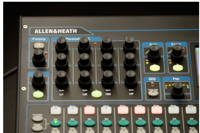
Einer für alle: Der „Superstrip“ dient als Steuereinheit für alle 16 Kanalzüge.
