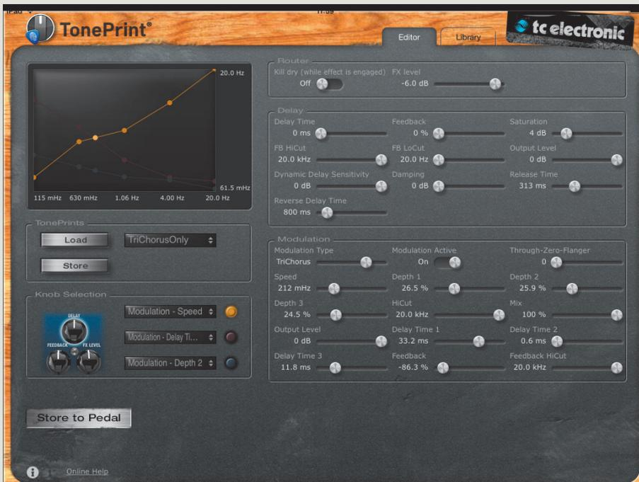
Per PC, Mac oder iPad (mit USB-Kamera-Adapter) kann man sich tief ins Innenleben der digitalen Effektprozessoren ein-hacken. So ist es z. B. auch wie im Bild möglich, das Flashback Mini Delay als Chorus-Pedal zweckzuentfremden.
