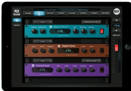
Effekt-Rack für drei Send-FX. Das untere Gerät kann entweder als 2. Delay oder Modulations-Effekt (Chorus-Flanger, Tremolo oder Pitch-Shifter) belegt werden.
