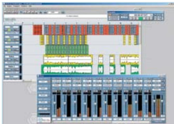
Die Software Kristal audio Engine ist ein einfach zu erlernender und übersichtlich gestalteter Sequenzer nur für Audio-Spuren. Maximal 16 Spuren lassen sich aufnehmen. Jede Spur enthält dabei einen Vierband-Equalizer und erlaubt die Integration von zwei VST-Effekten.
