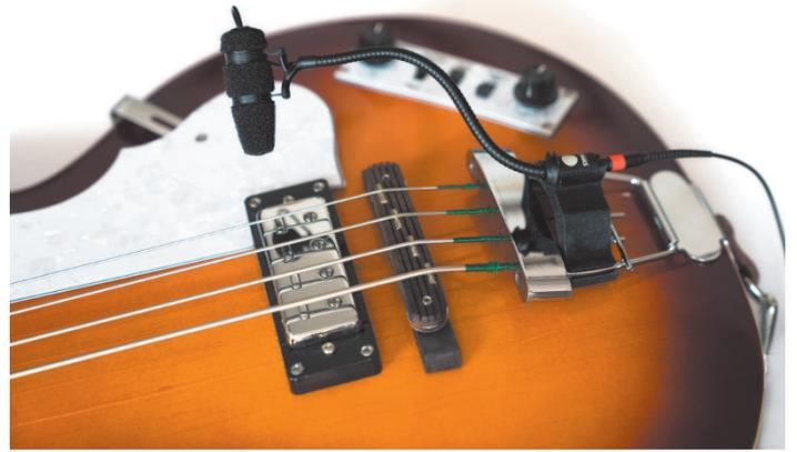
Hier wird die fürs Cello designte Halterung für den Höfner Violinbass zweckentfremdet. Elektrisches und akustische Signal ergeben zusammen eine glaubhafte Kontrabass-Simulation.
