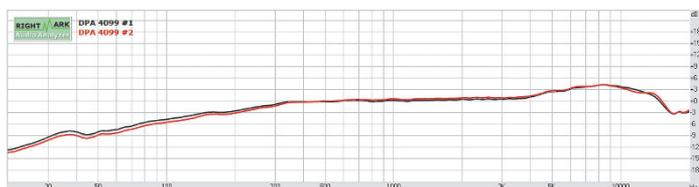
Zur Kompensation des Nahbesprechungseffekts hat das d:vote CORE 4099 eine Bassabsenkung, die bei 300 Hz einsetzt. Die Mitten werden sehr linear abgebildet; die Höhen sind leicht angehoben. Beide Exemplare, obwohl nicht als Stereopaar selektiert, haben nahezu identische Frequenzgänge, was für geringe Fertigungstoleranzen spricht.
