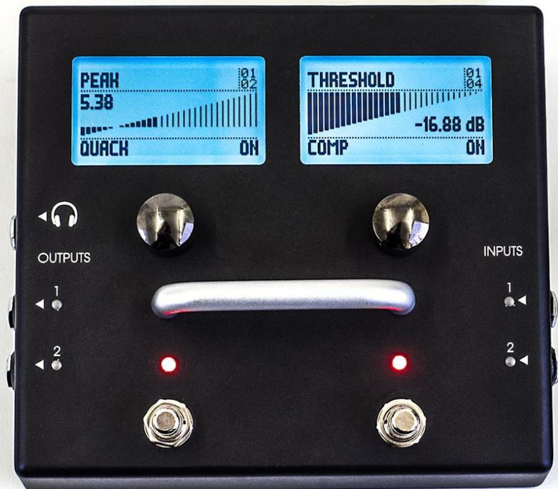
Das Gehäuse des Mod Duo ist absolut roadtauglich. Eine Metallstrebe schützt die Drehregler vor Fußstritten.
