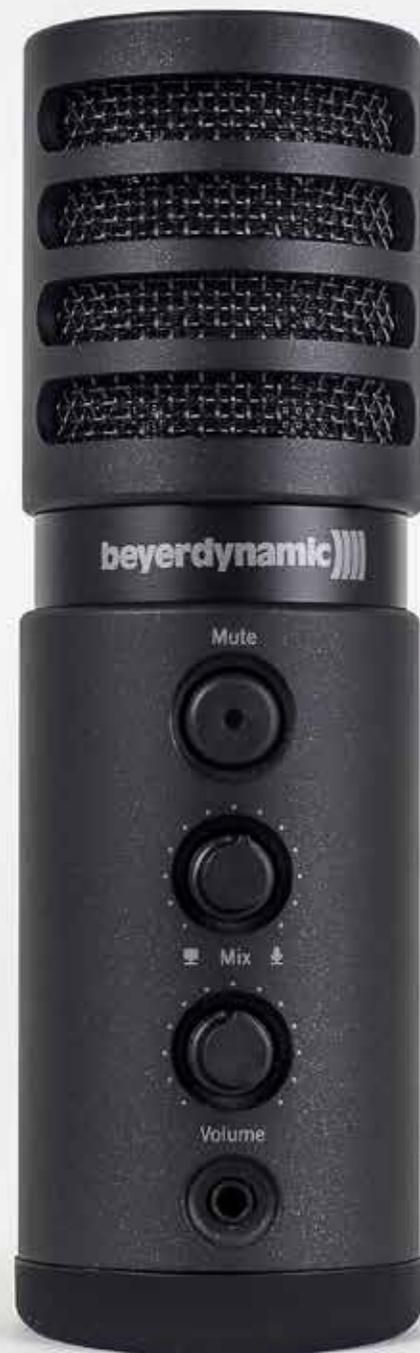
Ein simples Bedienkonzept: Oben der Muteschalter zum Stummschalten, darunter der Mix-Regler für das Verhältnis Computersignal- Aufnahmesignal. Der Kopfhörerausgang (unten) wird separat geregelt.
