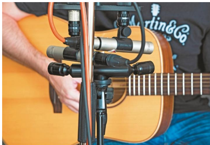
Der größte Vorteil des Superlux S502 liegt in der sofortigen Einsetzbarkeit. Mit üblichen Kleinmembranmikros ist der Aufbau einer ORTF-Anordnung ziemlich fummelig und zeitraubend.
