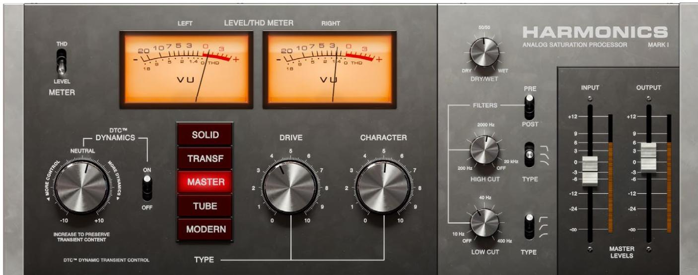
Mit DTC Dynamics lassen sich aus dem Signal entfernte Dynamiken wieder herstellen.
