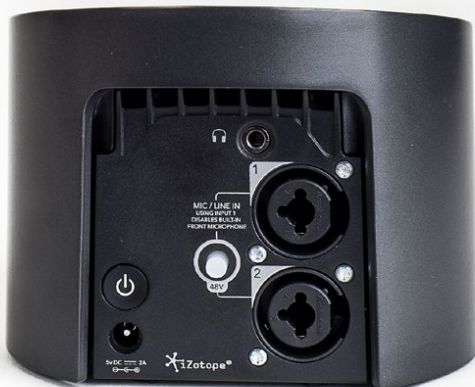
Auf der Rückseite sitzen die beiden XLR/TRS-Kombobuchsen mit zuschaltbarer Phantomspannung, der Anschluss für das mitgelieferte Netzteil sowie der Power-Schalter.
