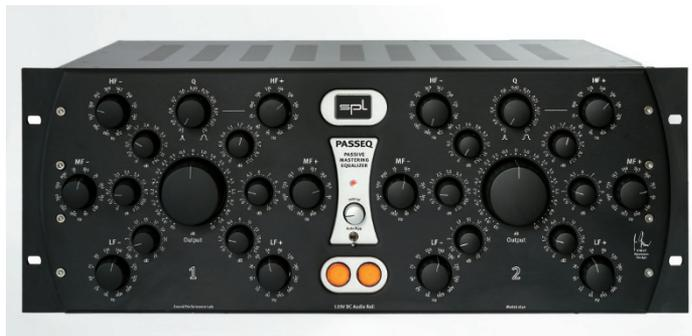
Der Passeq ist ein Mastering-EQ mit passiven Filterschaltungen: Pro Kanal bietet er für Bass, Mitten und Höhen separate Cut- und Boost-Bänder mit je 12 Einsatzfrequenzen. Die Aufholverstärker arbeiten mit SPLs 120-Volt-Technik.
