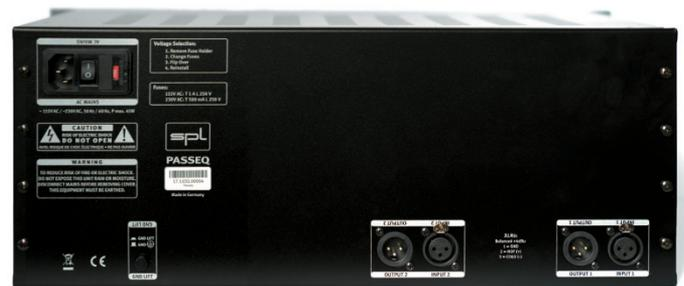
So imposant die Front, so »langweilig« die Rückseite: Hier gibt's nur zwei Ein- und Ausgänge als XLR-Buchsen und den Netzschalter. Ein Ground-Lift-Schalter hilft, Brumm Schleifen aufzutrennen.
