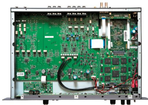
Das Innenleben ist sehr sauber und hochwertig aufgebaut. Die Vorverstärker (links) sind um Texas Instruments PGA2500-Chips aufgebaut, analoge Preamp-Chips mit digitaler Steuerung.
