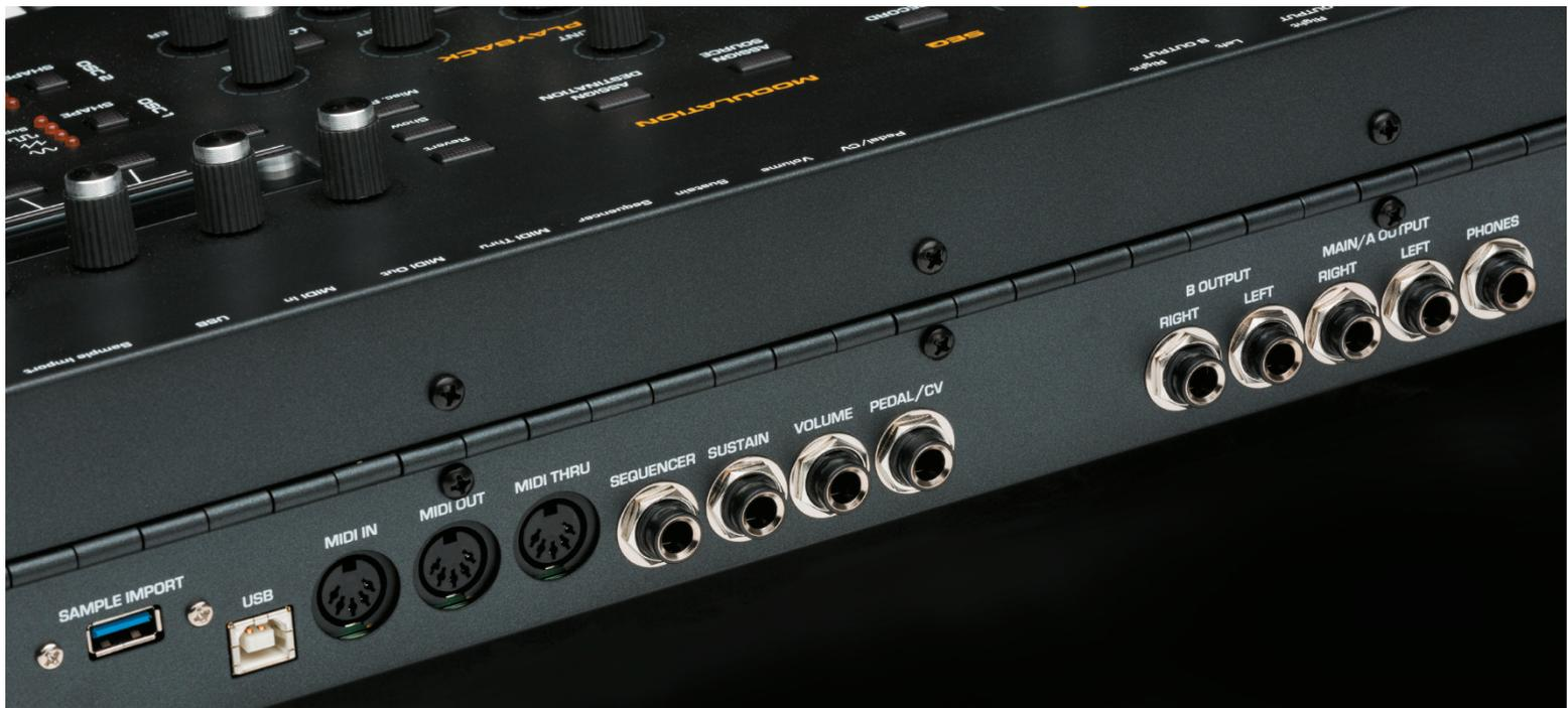
Auf der Rückseite des Prophet X findet man folgende Anschlüsse: Buchse für das externe Netzteil, MIDI-In- und Out, USB-MIDI, USB-Port für den Import eigener Samples via Stick, zweimal Stereo Out, Expression- Volume- und Sustain-Pedal, Fußschalter-Anschluss zum Starten des Sequenzers, Kopfhörerausgang.
