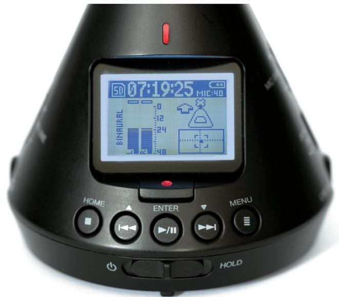
Die Menüsteuerung über fünf Taster ist etwas fummeliger als bei anderen Zoom-Rekordern neueren Datums. Rechts unten im Display wird die Positionierung angezeigt, dank Gyrosensor.
