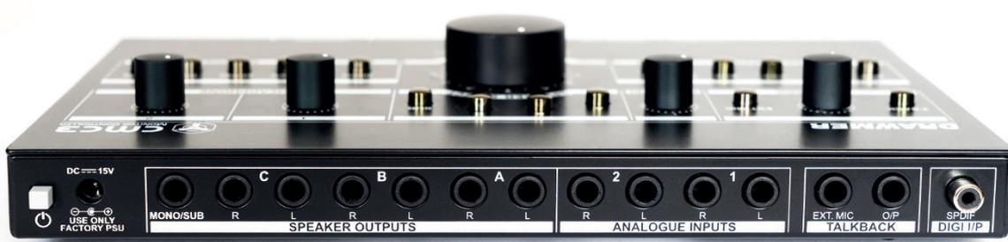
Das Anschlussfeld auf der Rückseite: ein Digitaleingang, zwei analoge Inputs und drei Ausgangspaare plus Mono/Sub-Out; dazu Anschlüsse für Talkback
