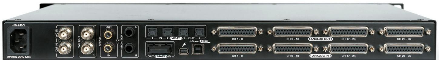
Auf der Rückseite drängen sich die Anschlüsse dicht an dicht. Links die digitalen Ein- und Ausgänge in Form zweier ADAT-Lichtleiter-Anschlusspaare, MADI, und S/P-DIF; außerdem ein analoger Monitor-Out mit 129 dB Dynamik, dazu WordClock-In und 10M-In für externe Clocks sowie zwei WordClock-Outs. Als Computerschnittstellen stehen USB 2.0 und Thunderbolt zur Verfügung. Rechts je 32 analoge Ein- und Ausgänge in Form von acht DB25-Steckverbindern
