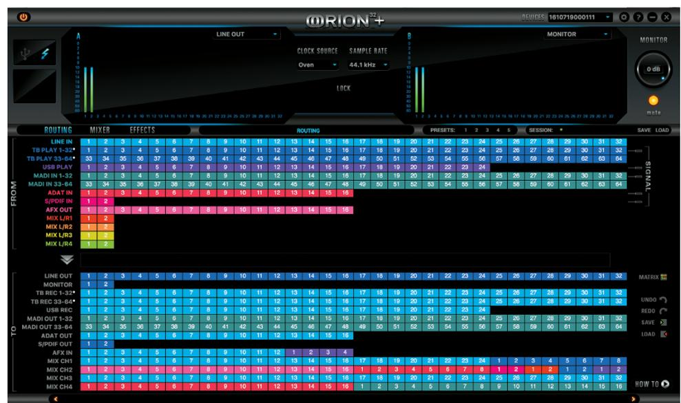
Die Zuordnung der Hardware- und Software-Kanäle wird in der Routing-Matrix per Drag&Drop vorgenommen.
