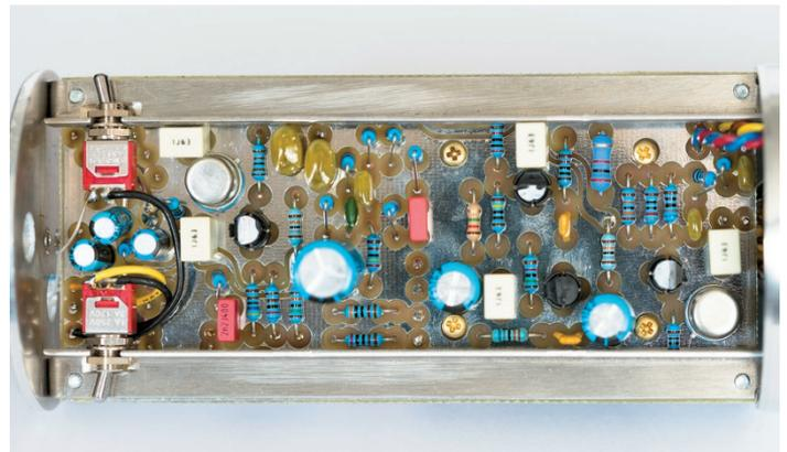
Die Mikrofonelektronik, die an die Schaltungen der TG Pulte angelehnt ist, ist klassisch mit bedrahteten Bauteilen aufgebaut und wirkt sehr sauber verarbeitet.
