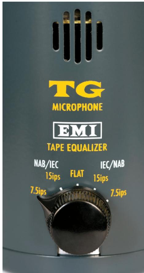
Die Presets des EMI Tape EQ dienten eigentlich der Anpassung von Bändern, die nach verschiedenen Standards bzw. mit unterschiedlichen Geschwindigkeiten aufgenommen wurden. Entsprechend kryptisch ist die Beschriftung.
