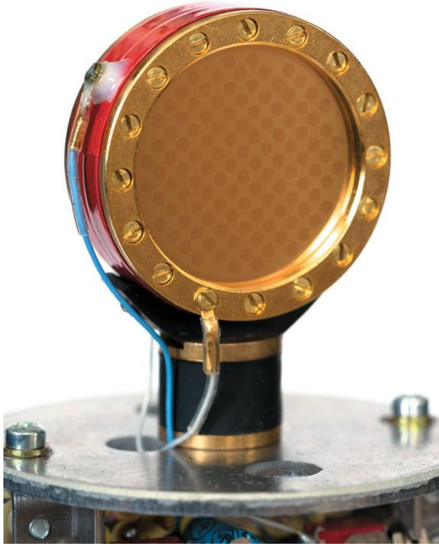
Das Chandler TG Mic arbeitet mit einer randkontaktierten Großmembrankapsel.
