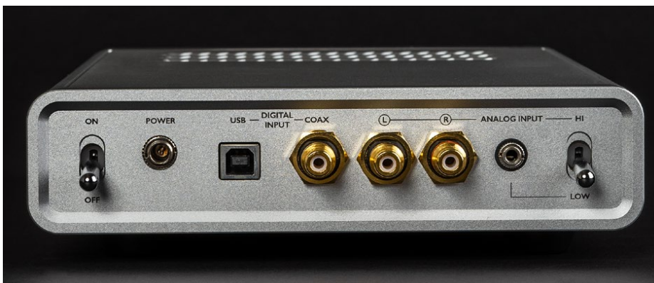
Auf der Rückseite befinden sich der An/Aus-Schalter sowie diverse analoge und digitale Anschlüsse.
