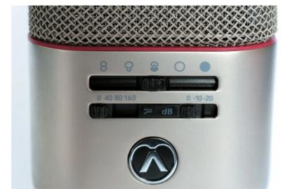
Back to the Roots: Statt Tipptasten mit Display verwendet das OC818 Schiebeschalter, die auch ohne Stromzufuhr die Betriebszustände anzeigen. Acht, Hyperniere, Niere und Kugel sind direkt anwählbar, die fünfte Position ist ein wählbares Preset, das ab Werk mit einer breiten Nierencharakteristik belegt ist.
