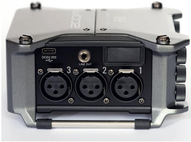
Die linke Seite des F6 mit Mikrofoneingängen, Line-Out, einem Slot für den optionalen Bluetooth-Dongle sowie einem USB-Anschluss
