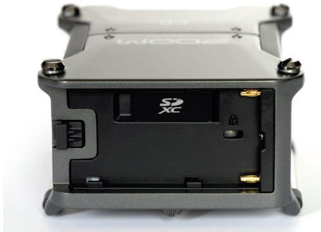
Auf der Rückseite befindet sich der Kartenschacht für SD bzw. SDXC-Speichermedien. Außerdem kann hier ein Lithium-Akku im Sony-L-Series-Format angebracht werden.
