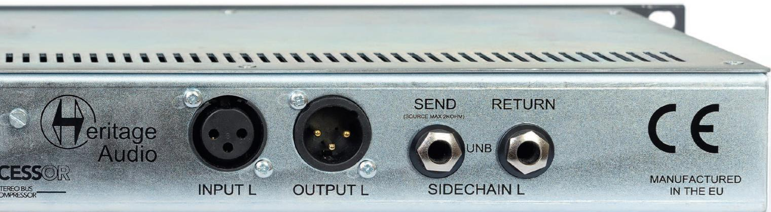
Die Ein- und Ausgänge sind als professionelle XLR-Steckverbinder ausgeführt: die Sidechains beider Kanäle sind über Inserts (Klinke, unsymmetrisch) zugänglich. Die Stromversorgung erfolgt über ein externes Netzteil.
