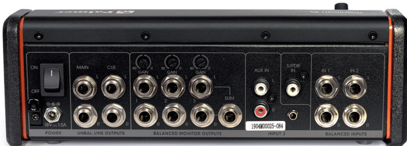
Bis auf die Kopfhörerausgänge befinden sich alle Anschlüsse auf der Rückseite. Es kommen größtenteils Klinkenbuchsen zum Einsatz, die bis auf die Main- und Cue-Outs symmetrisch beschaltet sind. Eine Besonderheit ist der koaxiale S/PDIF-Digitaleingang. Gespeist wird der Monicon XL über ein externes Netzteil.
