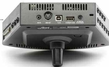
Anschlüsse Rückseite: Aux In, MDI Out, USB-B (to PC), USB-A (to Memory Drive), Netzanschluss
