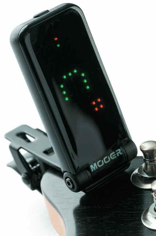
bot. Leider gibt das Manual keine Auskunft über die Stimmgenauigkeit. Um die CR2032 Batterie zu schonen, schaltet sich der CT-01 nach etwa einer Minute aus, sofern er keine Schwingungen mehr feststellt. Neben A- und E-Gitarre und A- und E-Bass versteht sich der Mooer Clip Tuner auch bestens mit Ukulelen, Mandolinen und vielen anderen Zupfinstrumenten an denen er Halt findet.
