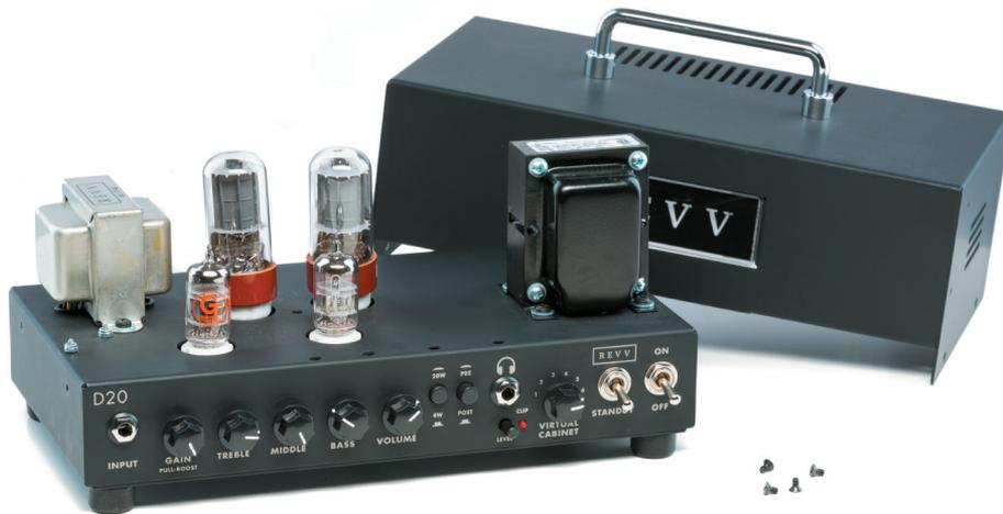
zudem kann ich nur Gutes vom Röhrenwechsel berichten. Das Gehäuse lässt sich prima durch das Lösen von nur vier Schrauben an den Seiten öffnen und die defekte Röhre war sehr einfach aus ihrem überraschend hochwertigen Keramiksockel gelöst und schnell durch eine neue 12AX7 gleicher Bauart ersetzt. Das könnte man notfalls sogar mal eben zwischen zwei Songs auf der Bühne erledigen, so bequem in zwei Minuten.
