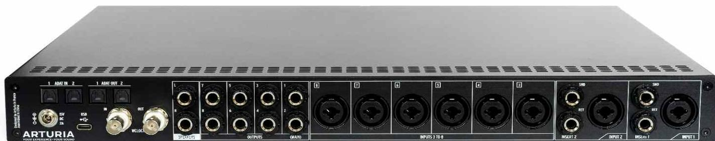
Die Eingänge sind als Combobuchsen ausgeführt, was beim Rack-Einbau den Wechsel zwischen Mic/Line-Modus erschwert. Die ersten beiden Eingänge, die auf der Frontplatte gespiegelt sind, bieten zusätzlich symmetrische Inserts. Die Outputs sind als Klinkenbuchsen ausgeführt. Über zwei Lichtleiteranschlusspaare können externe Wandler eingebunden werden. Wahlweise kann das AudioFuse 8Pre auch selbst zum ADAT-Wandler umkonfiguriert werden.
