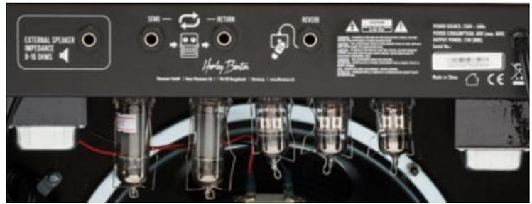
Röhrenbestückung und Anschlussmöglichkeiten des Tube 15
