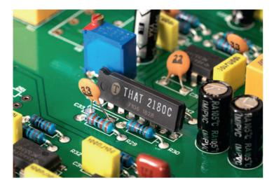
Wie beim Original kommen hochwertige VCA-Bausteine von THAT zum Einsatz, allerdings in der C-Sortierung mit etwas höheren Verzerrungswerten. SSL verwendet mehrere parallel verdrahtete Bausteine in der A-Sortierung für maximale Transparenz.
