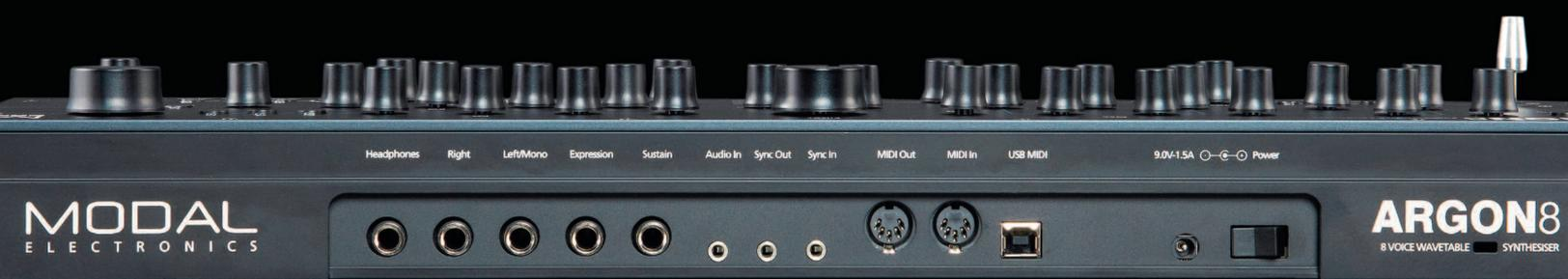
Auf der Rückseite sind zahlreiche Anschlüsse vorhanden: Kopfhörer- und Stereo-Ausgänge, zwei Pedal-Eingänge, Stereo-Audio-Eingang, Sync-In/Out, MIDI-In/Out (DIN), USB-MIDI-Buchse sowie der Netzteilanschluss und Ein/Aus-Schalter.
