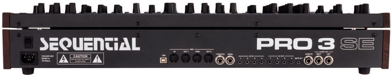
CV- und Gate-Schnittstellen erweitern die Flexibilität und erlauben die Anbindung an modulare Systeme.
